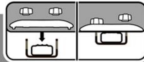
**Универсальное** крепление для установки бокса на обычные поперечины.
