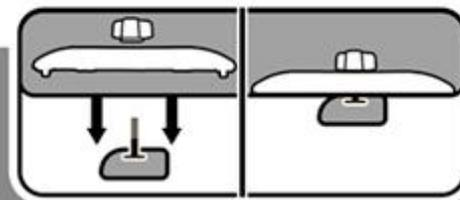
T-образное крепление для установки бокса на **аэродинамические** поперечины.
